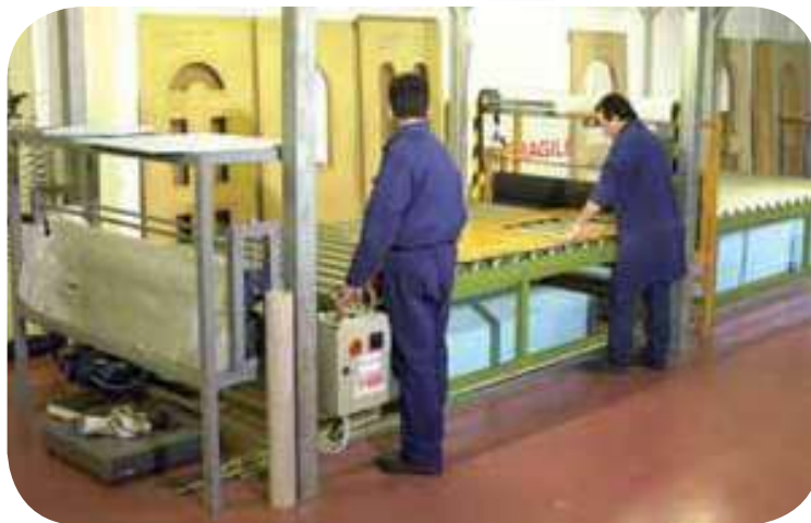
Avvolgimento pellicole di protezione e dogatura pannelli Protective Plastic Wrapping and Panel Stave
